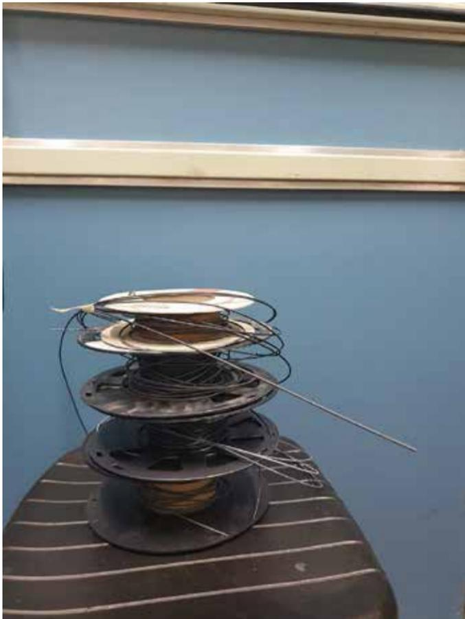
Imagen superior : filamentos con fibras de carbon de caña de bambú. Abajo: el ingeniero Rodrigo de Prada trabaja con la extrusora de filamento para impresión 3D
