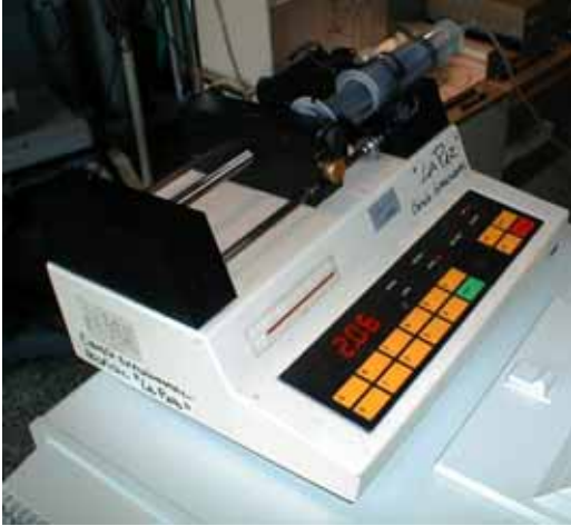
Figura 14-1. Bomba de infusión de jeringa de fármacos o fluidos
