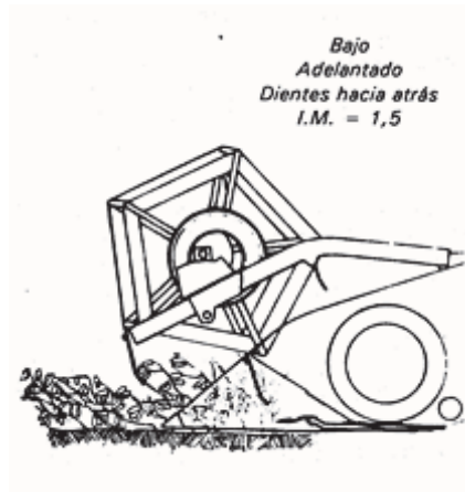
Figura 26. Regulación del molinete para cultivos volcados.
