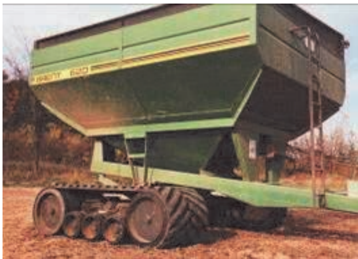
Figura 26. Banda de caucho de bajo perfil, alta flotabilidad, bajas huellas, excesivo costo y poca adaptación para el barro.
