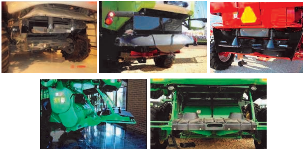
Figuras 10. Nuevos sistemas de distribución de los residuos, con regulación de giro hidráulico, lo que posibilita regular la intensidad de la distribución según el estado del rastrojo y distribuir correctamente el rastrojo en grandes anchos de labor. Fuente: INTA PRECOP, 2007.
