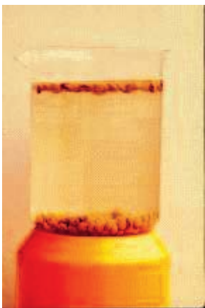
Figura 5. Método del Hipoclorito: evaluación química del porcentaje de daño mecánico en Soja.
