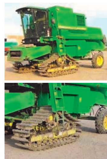
Figura 12. Cosechadoras con orugas de metal tipo arrocera de buena prestación para situaciones de cosecha con agua en superficie.
