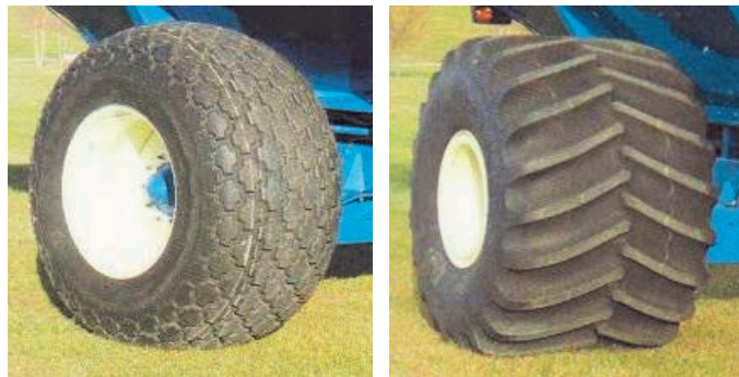
Figura 28. Der.: Neumático radial de baja agresión al suelo, dibujo tipo rombo. Ideal para acoplados tolvas. Izq.: Detalle de neumático radial de alta flotabilidad, gran ancho y largo con pisada plana de su banda de rodamiento.
