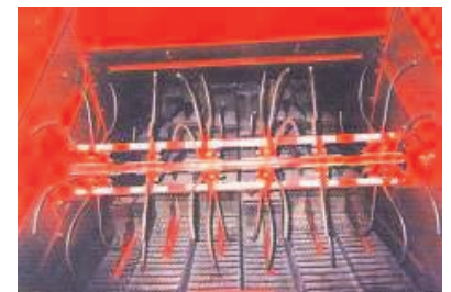
Figura 3. Rotor agitador transversal. Esquema de vista lateral (arriba). Fotografía de vista posterior (abajo).
