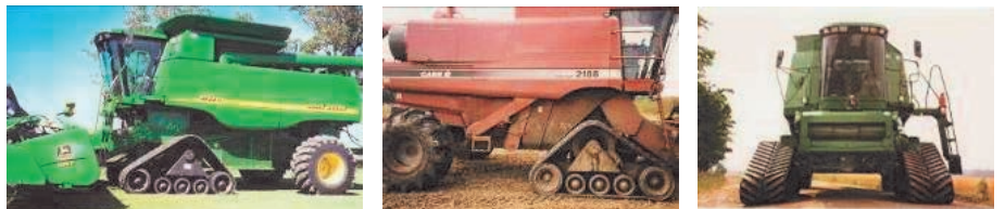
Figura 14. Las orugas con banda de caucho fueron diseñados para reducir la presión específica sobre el suelo, pero poseen regular adaptación para funcionar en el barro. Son una buena solución para trabajos en situación de suelos húmedos evitando huellas.
