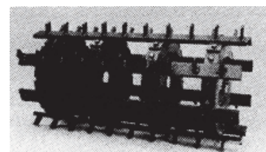
Figura 8. Cilindro de dientes tipo planchuelas
