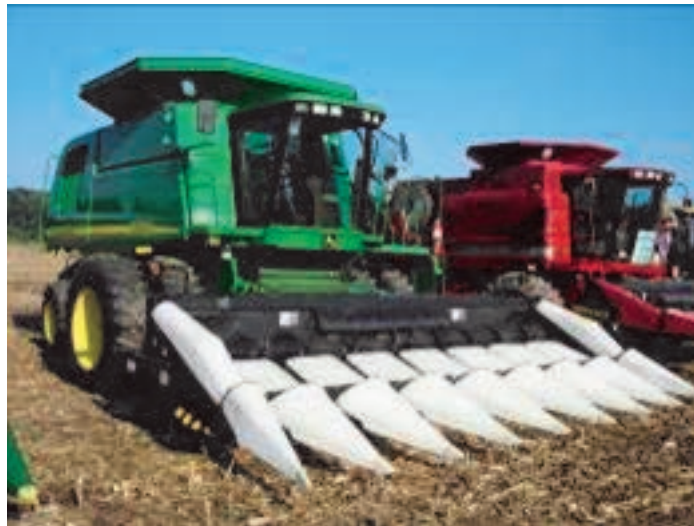
Figura 23. Cosechadora Maxi, equipada con duales 6 x 4, doble tracción con cabezal de maíz de reducido ancho para evitar excesivo peso y también las oscilaciones laterales del cabezal ancho.
