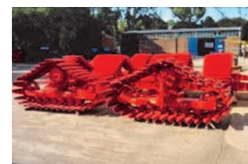
Figura 13. Orugas metálicas para cosecha de granos con falta de piso de origen nacional.
