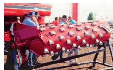
Figura 17. Rotor de la cosechadora axial.
