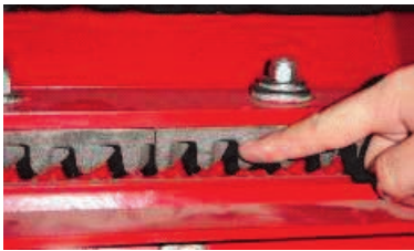
Figura 2. Barras batidoras con alabes de mayor separación y profundidad
