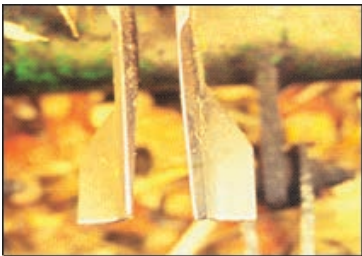
Figura 3. Cuchilla del triturador tipo paleta, que genera una mayor corriente de aire, mayor velocidad de salida del material picado y mejor uniformidad de distribución.
