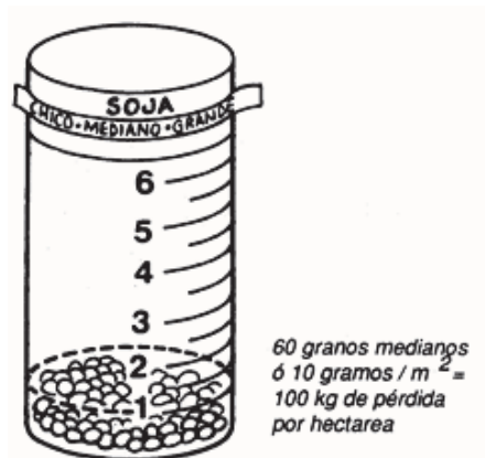
Figura 4. Recipiente diseñado por INTA, para evaluación de pérdidas.
