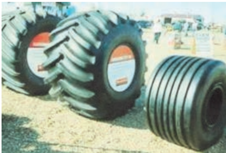
Figura 16. Neumáticos de alta flotación, carcasa radial, baja presión de inflado. Reducen el huellado y la compactación superficial del suelo. De este tipo de neumático existe un diseño especial para cada exigencia y tipo de máquina agrícola
