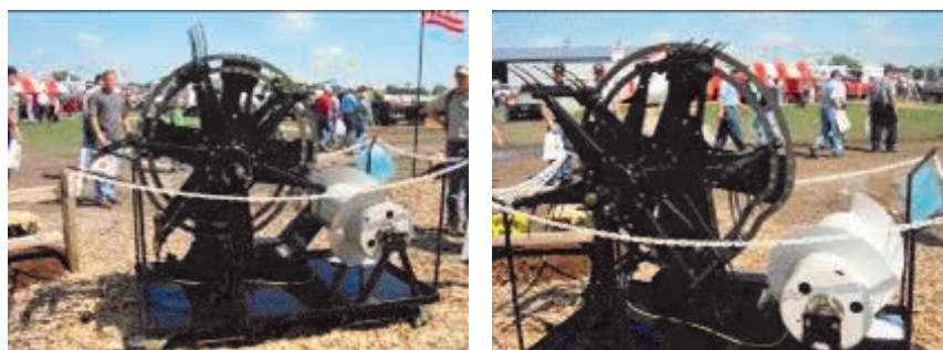
Figuras 37. Detalle del Molinete orbital “Orbit Reel” de origen americano. A = Detalle de la forma de entrada y salida del diente, y B = Modificación del excéntrico o guía del diente para permitir acercarse más el molinete al cabezal, eliminando la zona de acumulación. HCC, Inc. – www.hccincorporated.com
