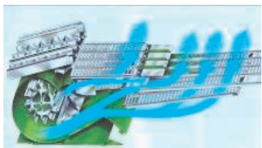
Figura 12. Sistema de limpieza de nueva generación. Se observan las desviaciones en el recorrido del aire, la mayor superficie de limpieza al utilizar una mesa de preparación con aire y cribas y la uniformidad de entrega del aire por la turbina.
