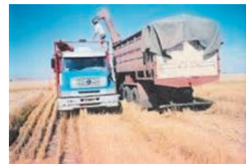
Figura 24. Nunca ingresar con camiones al rastrojo. El neumático de camión posee la máxima presión de inflado, por ende la máxima capacidad de compactación.
