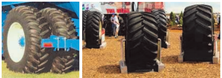
Figura 29. Der.: Neumático dual radial para tolva, colocado en balancín para cargas puntuales sobre el suelo y huellado. Izq.: Diferentes alternativas de neumáticos radiales para cosechadoras y tolvas. Diámetro y carcasa radial que alarga la pisada ayudado por el perfil plano de banda de rodamiento. Todos estos neumáticos soportan altas cargas con baja presión de inflado, lo cual disminuye la presión específica sobre el suelo y por ende, las huellas, aumentando la transitabilidad en suelos húmedos y con baja sustentación.
