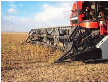
Figura 33. Vista del kit de correas de goma Cobra colocado en la cosechadora evaluada.
