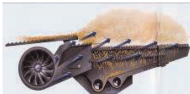
Figura 11. Sistema de limpieza de nueva generación. Se observan las desviaciones en el recorrido del aire, lo que provoca una 1er separación neumática por diferencia de peso específico entre el grano y la granza.
