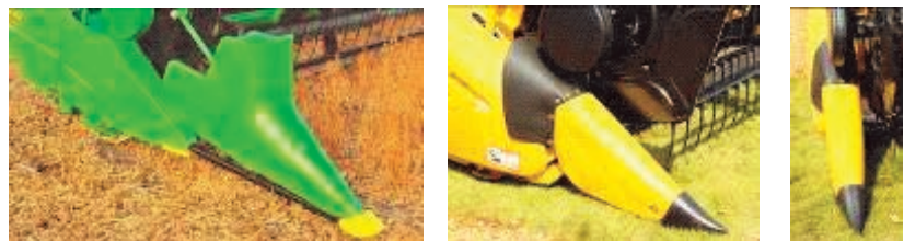
Figura 50. Puntones laterales de materiales plásticos con nuevo diseño. Nótese el diseño ultraliviano de los mismos, como así también sus bajas dimensiones.
