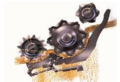
Figura 10. Sistema de trilla con acelerador y colado de grano progresivo.
