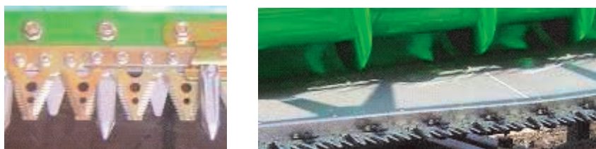
Figura 16. Vista de los diseños de barra de corte de 2" x 2" con recorrido de 3,5" (cabezales serie 600). Fuente: John Deere company.
