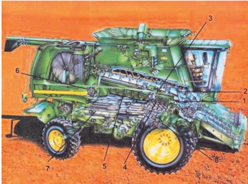
Figura 13. Esquema de una cosechadora de flujo axial (John Deere Ind.): 1) cono de entrada, 2) rotor, 3) barras batidoras, 4) cóncavos de trilla, 5) cóncavos de separación, 6) despajador de descarga, 7) zarandas de limpieza, 8) turbina de aire.
