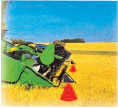
Figura 55. Esquema del sensor ultrasónico colocado a ambos extremos de un cabezal de gran ancho de labor. Fuente: www.norac.ca
