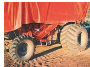
Figura 17. Cosechadoras 4x2, neumáticos Terra Tyre, de baja presión de inflado, ideal para reducir el huellado en terrenos normales. Buena flotabilidad, baja compactación pero escasa tracción en suelos con falta de piso y barro.
