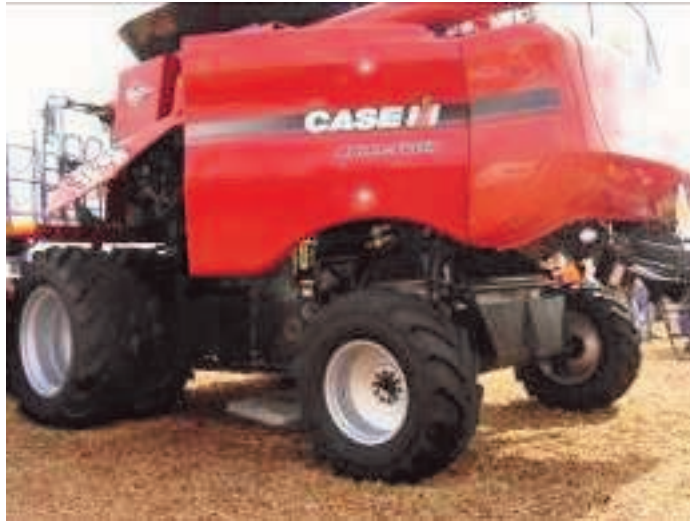
Figura 22. Cosechadora 6 x 2 con duales delanteras de gran diámetro y ancho con carroza radial y tacos a 45º, rodado trasero de gran diámetro y ancho lo cual mejora sustancialmente su flotabilidad y reduce las huellas en situación de falla de piso
