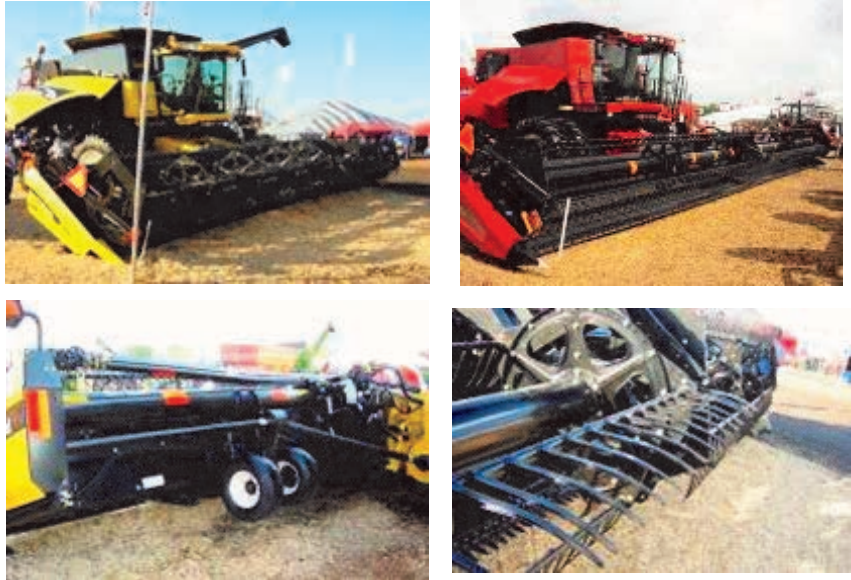
Figura 52. Detalle de las cosechadoras NH y Case, con cabezal de lonas de 36 y 40 pie de ancho de corte respectivamente; también se observan las ruedas que sostienen y guían los laterales articulados. En las últimas fotos se aprecia el molinete doble de diseño orbital incorporado de serie.
