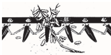
Figura 11. Movimiento lateral de la planta con el sistema de corte 3 x 3 "convencional".
