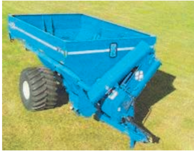
Figura 27. Neumático radial de gran diámetro y ancho. Ideal para aumentar la flotabilidad y transitabilidad. Cuando falta piso se debe trabajar a media carga.
