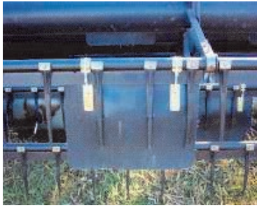
Figura 32. Correas para plantas de Soja pequeñas (Vista), con kit para colocar y extraer en forma rápida “Sistema Cobra”.
