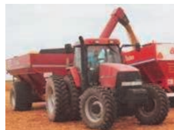
Figura 25. Los acoplados tolva deben ser traccionados por tractores 4x4 articulados, o 4x4 asistidos en lo posible con duales en el tren trasero. Nada se logra con acoplados tolvas con neumáticos de alta flotación si el tractor no forma un equipo acorde. El equipo de la foto es armónico.
