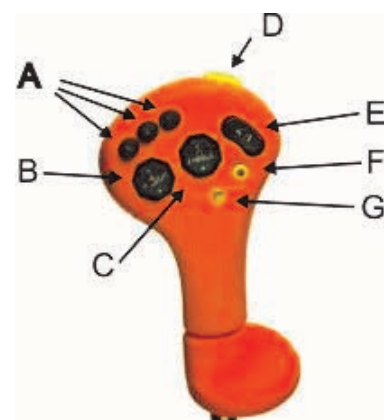
Figura 30. Palanca “command touch” multifunción. A) memorias de regulación programables, B) Control de molinete, C) Control de cabezal, D) Parada de emergencia, E) Giro de sinfín de descarga, F) Acoplamiento sinfín, G) Luz de advertencia para sinfín en funcionamiento.
