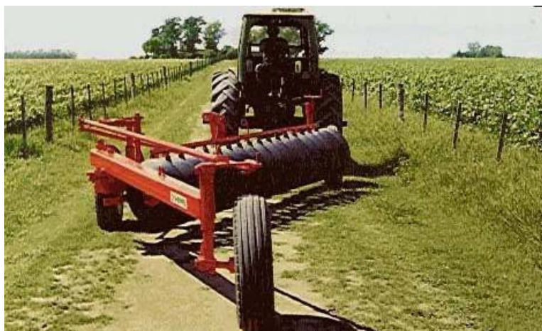
Arado-rastra con tren de discos dividido en secciones independientes y articuladas
