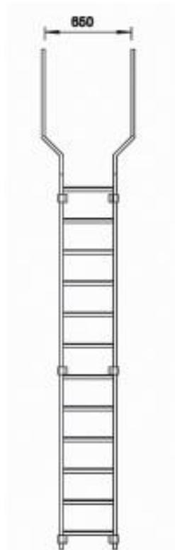
Fig. 3.- Esquema de la escalera con ensanchamiento en la parte final (dimensiones en mm).
